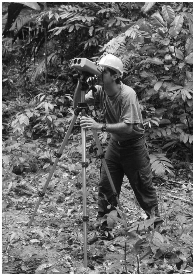
Figura 1. Dendrômetro a laser utilizado com tripé em medição de diâmetro. Figure 1. Laser dendrometer used with tripod in diameter measurement.
