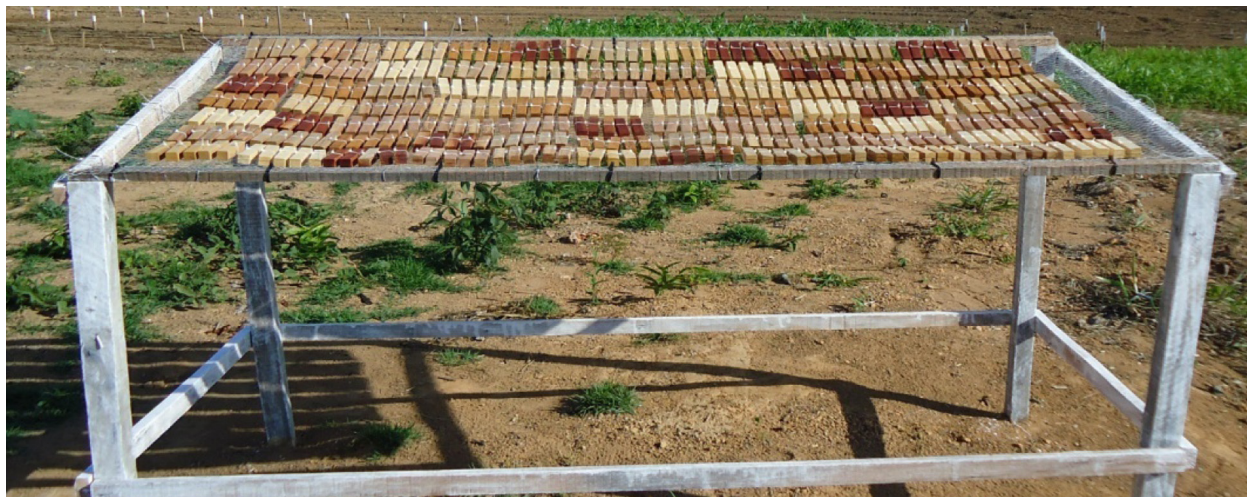
Figura 1. Plataforma inclinada utilizada nos ensaios de campo de secagem natural da madeira, com a face voltada para o Norte.
