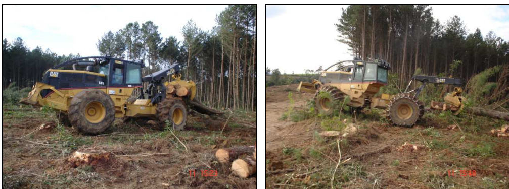
Figura 1. Skidders com rodados de pneus (esquerda) e rodados de pneus recobertos com semiesteiras (direita).
