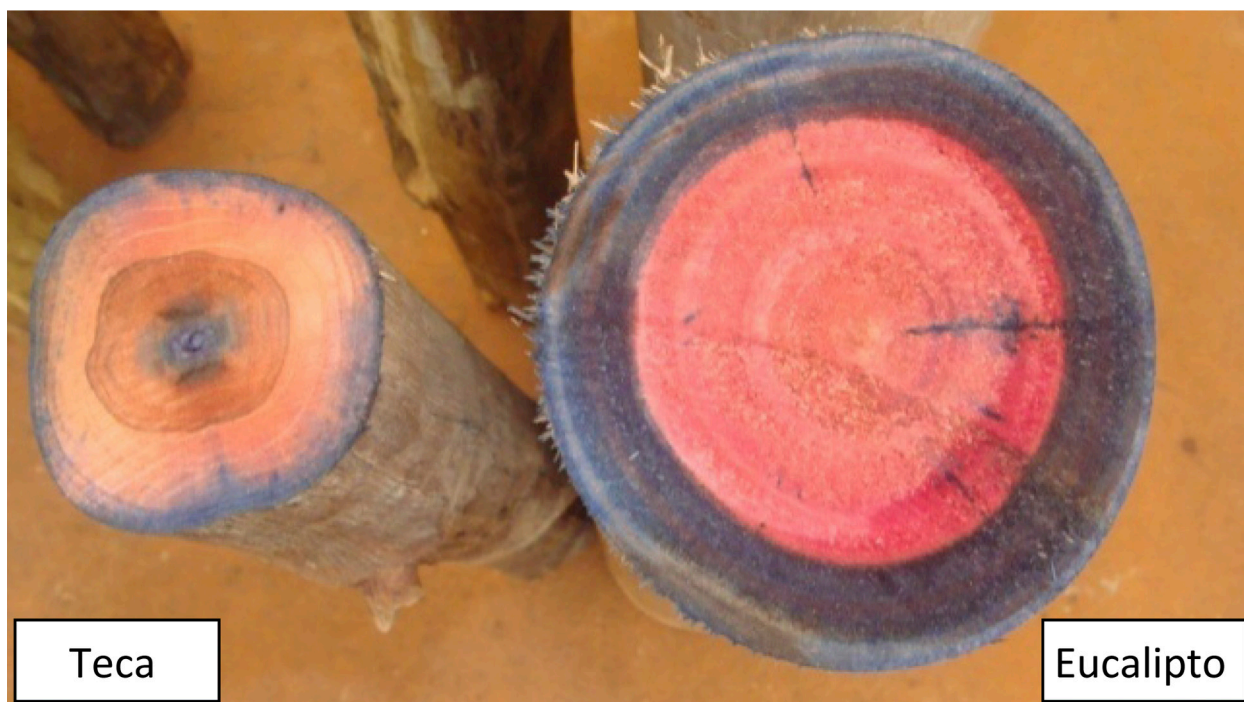
Figura 5. Madeiras de teca e eucalipto submetidas ao teste de cromoazurol-S após o tratamento preservativo simultâneo das duas espécies.
