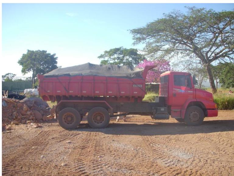
**Figura 6** - Caminhão basculante coberto com lona e carregado de resíduos de madeira.
