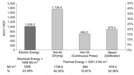
**FIGURE 2** Energy Demand in MDF production: Electrical versus Thermal Energy. **FIGURA 2** Demanda de Energia na Produção do MDF: Energia Elétrica versus Térmica.
