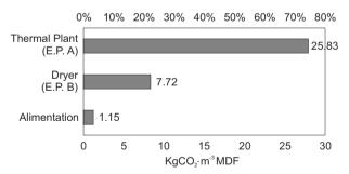
**FIGURE 4** CO<sub>2</sub> fossil contribution per elementary processes. **FIGURA 4** Contribuição do CO<sub>2</sub> fóssil por processos elementares.
