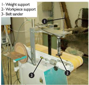
FIGURE 1Belt sander used in the experiment.FIGURA 1Lixadeira plana utilizada no experimento.
