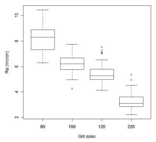
FIGURE 5 Influence of the grit sizes over surface roughness. FIGURA 5 Influência da granulometria sobre a rugosidade.
