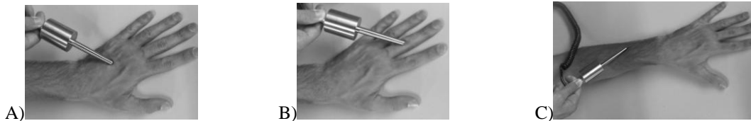
Figura 2. Coordenadas ortogonais ISO 5349-1 (A: eixo xx, B: eixo yy e C: eixo zz). Figure 2. Coordinated ortogonais ISO 5349-1 (A: axis xx, B: axis yy and C: axis zz).
