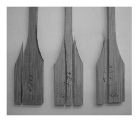
Figure 3. Specimens initially prepared for the tensile strength parallel to grain test.Figura 3. Corpos de prova inicialmente preparados para o ensaio de resistência à tração paralela às fibras.
