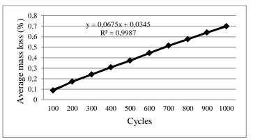
Figure 4. Average mass loss per cycle in the wear resistance test. Figura 4. Perda de massa média por ciclo no ensaio de resistência ao desgaste abrasivo.
