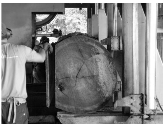
Figura 2. Desdobro principal na serra de fita para toras livres de defeitos. Figure 2. Non defect logs breakdown using a band saw.
