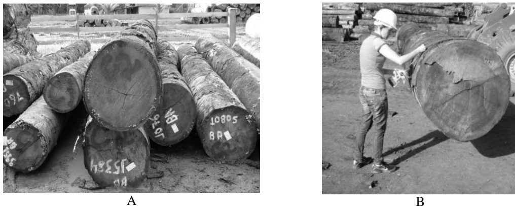
Figura 1. Classificação das toras por classes diamétricas (a) e medição do volume (b). Figure 1. Logs sorting in diametric classes (a) and volume measuring (b).
