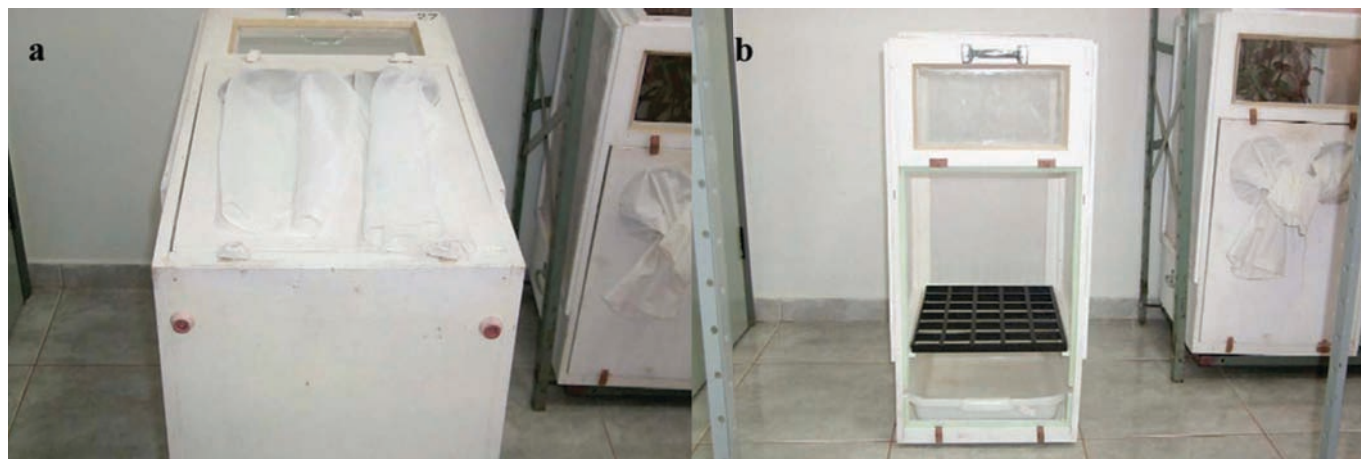
Figura 8. Representação da distribuição dos pés (a) e da colocação da bandeja de contenção de água (b). Figure 8. View of the feet distribution (a) and tray placing to contain water (b).
