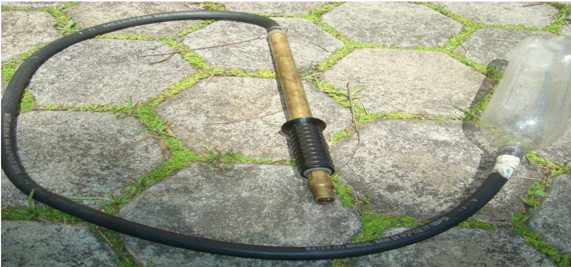
Figura 2 - Adaptação feita bico de bomba costal com garrafa pet.
