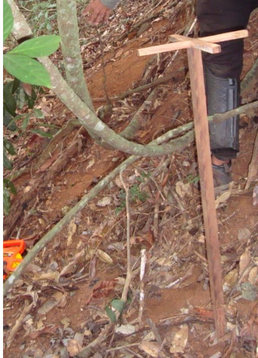
Figura 3 - Cruzeta de madeira utilizada em campo para delimitação dos pontos-quadrantes.
