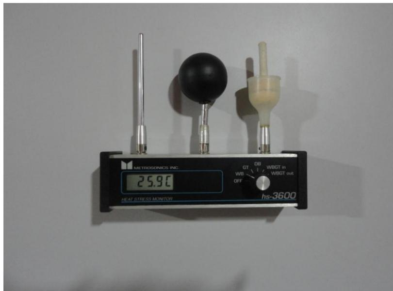
Figura 3 – Índice de Bulbo Úmido Termômetro de Globo.
