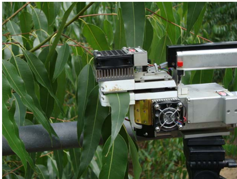
Figura 2 – Equipamentos usados em medições das trocas gasosas em clone de eucalipto.
