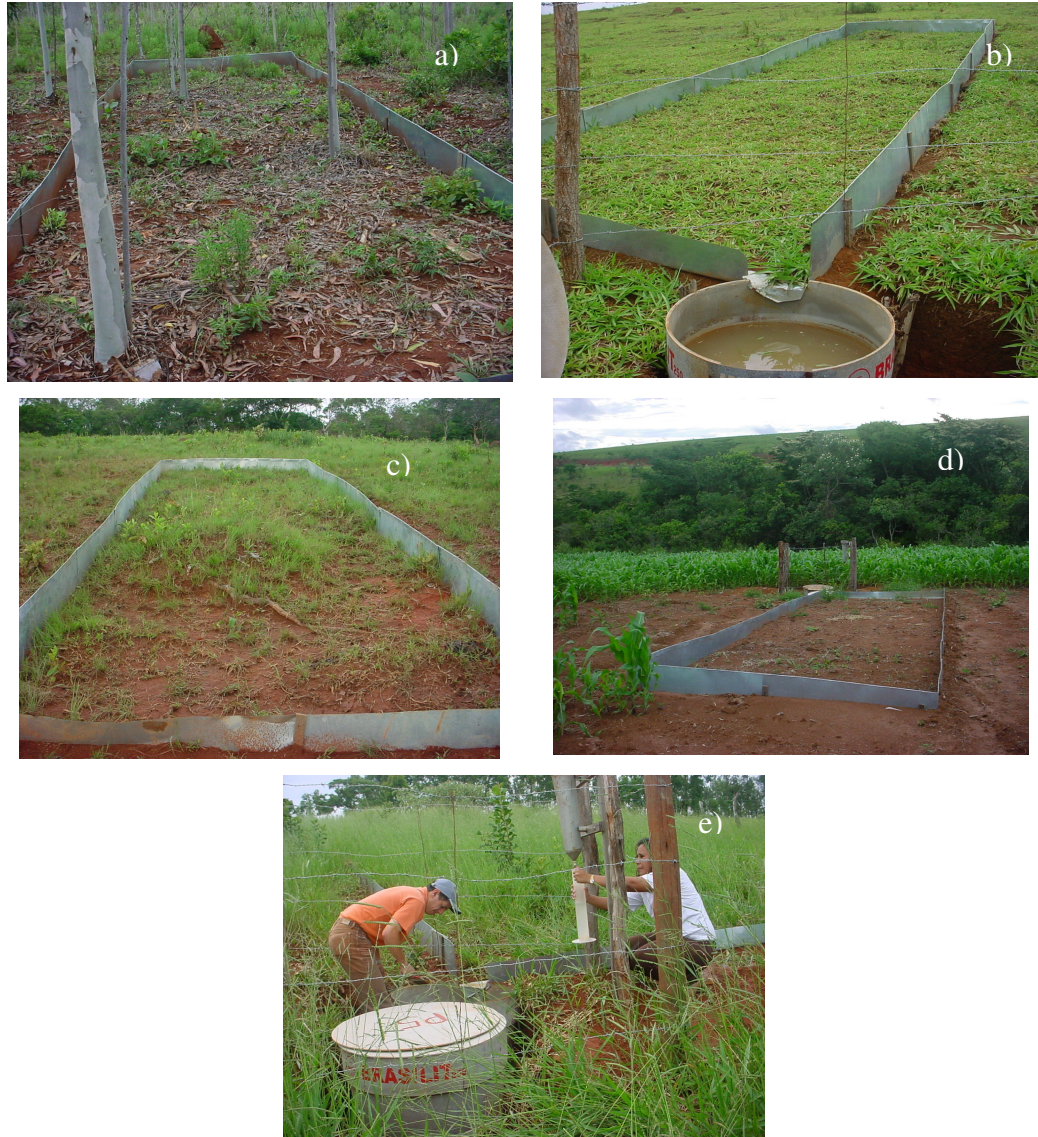
FIGURA 6 – Fotos das parcelas de perda de solo e água instaladas na sub-bacia hidrográfica do Ribeirão Marcela.
