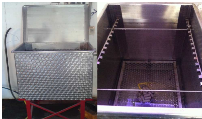
Figura 9 Caixa térmica utilizada para o pré-tratamento da madeira em água quente a 85 °C
