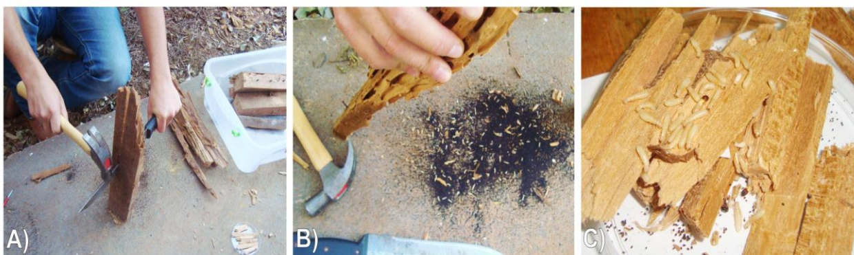
Figura 13. A) Procedimento da abertura das madeiras infectadas por Cryptotermes brevis ; B) Detalhe da retirada do C. brevis dentro das galerias da madeira Eucalyptus grandis e C) Insetos inseridos na placa de petri para o reconhecimento entre indivíduos antes do ensaio cupim x madeira.
