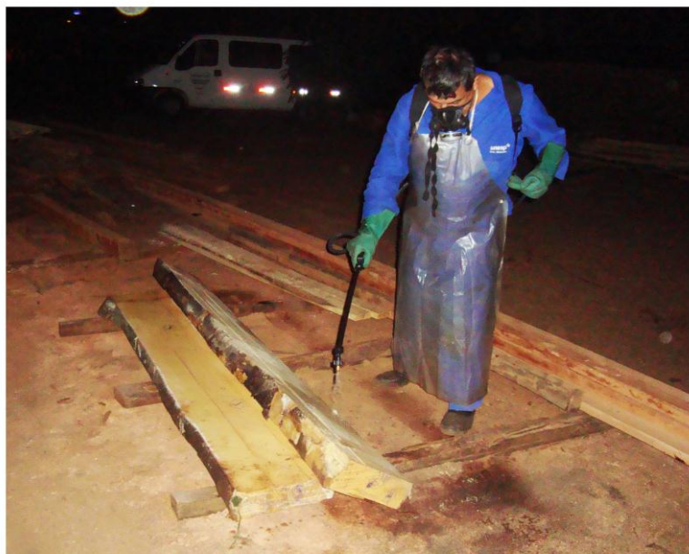
Figura 5. Aplicação do preservativo (2,4,6 –Tribromofenol) por pulverização na superfície do pranchão central afim evitar a possível infestação de fungos manchadores antes da retirada dos corpos de prova.
