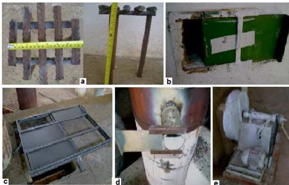
Figura 5 - Grupo aerotérmico do sistema gaseificador/combustor. (a) dimensões da grelha; (b) entrada lateral de ar; (c) entradas de ar sob o combustor; (d) entrada de ar no reator e (e) conjunto motor/ventilador centrífugo.
