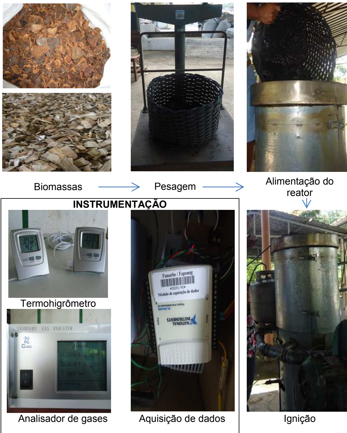
Figura 3.11 - Biomassas, reator de gaseificação e instrumentação utilizada para o controle do processo experimental.
