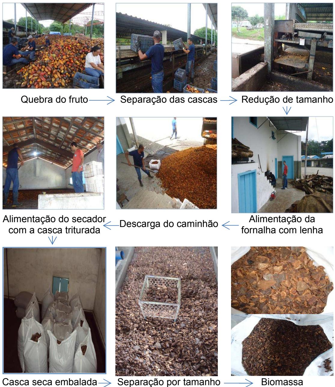
Figura 3.7 - Fluxograma do processo de obtenção da casca de cacau seca para ser utilizada como combustível sólido.
