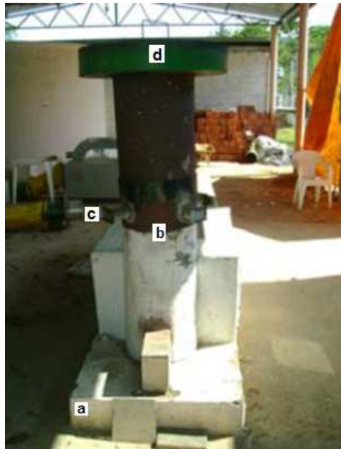
Figura 3 - Reator de gaseificação. (a) base do reator; (b) tubos de ferro; (c) entrada de ar primário; (d) tampa do reator.
