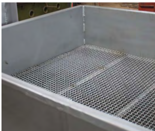
Figura 24 – Detalhe da câmara de secagem.
