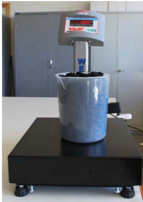
Figura 17 – Aparato para determinação da massa específica a granel do carvão do ouriço da castanha.
