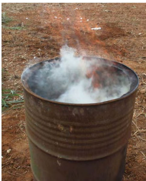
Figura 16 – Presença de chamas na parte superior do reator, caracterizando o momento de sua vedação.
