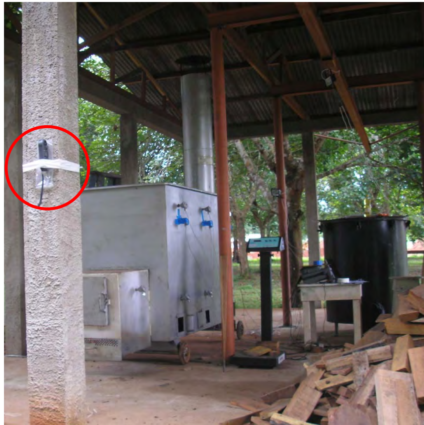
Figura 28 – Detalhe da localização do termohigroanemômetro em relação ao secador.
