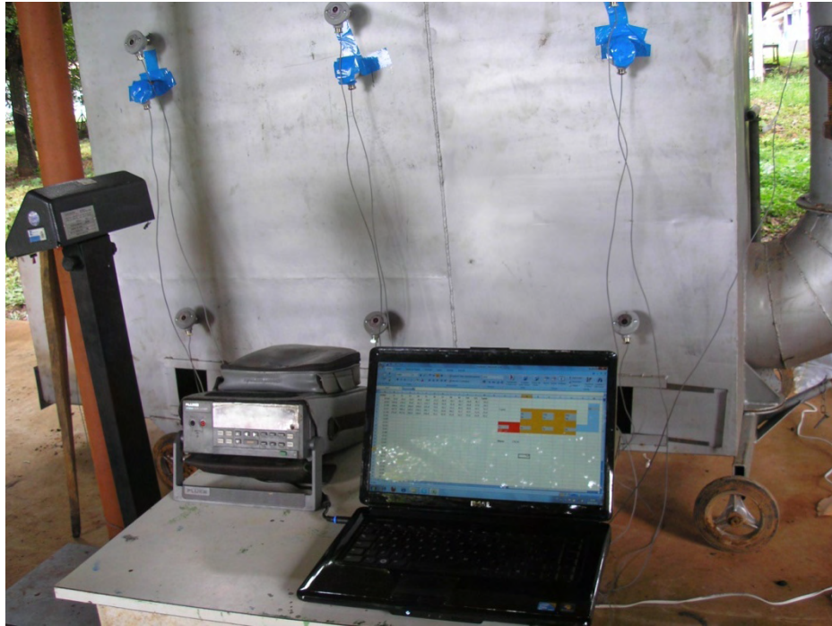
Figura 27 – Sistema de aquisição de dados e pontos de tomada de temperatura.
