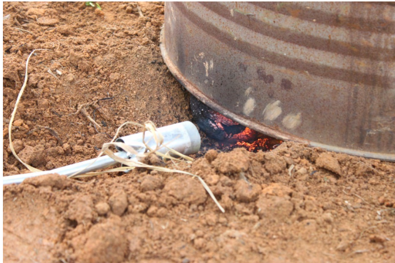
Figura 11 – Combustão dos ouriços localizados na base do reator para garantir a temperatura necessária à pirólise.
