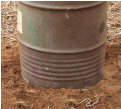
Figura 13 – Detalhe da vedação das entradas de comburente.
