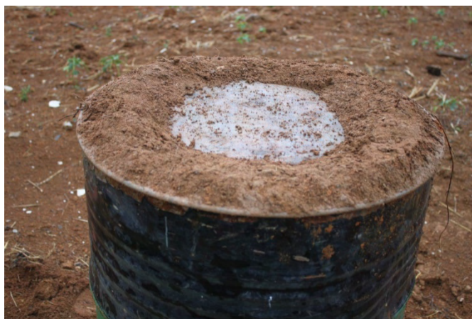
Figura 15 – Detalhe da vedação da parte superior do reator com massa.
