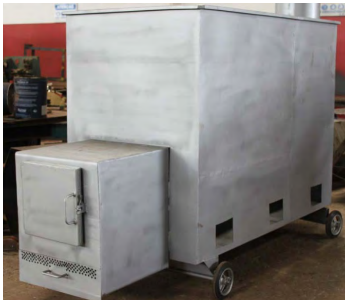
Figura 23 – Aberturas para entrada de ar ambiente na base da câmara plenum .
