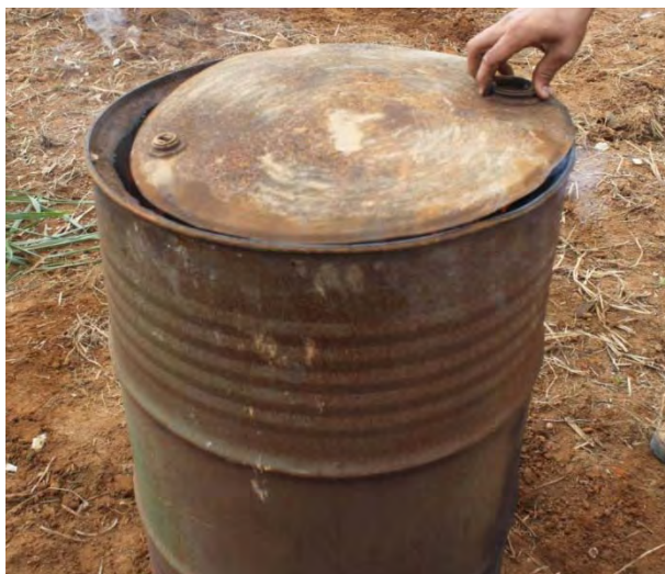
Figura 14 – Vedação do reator com a tampa metálica.
