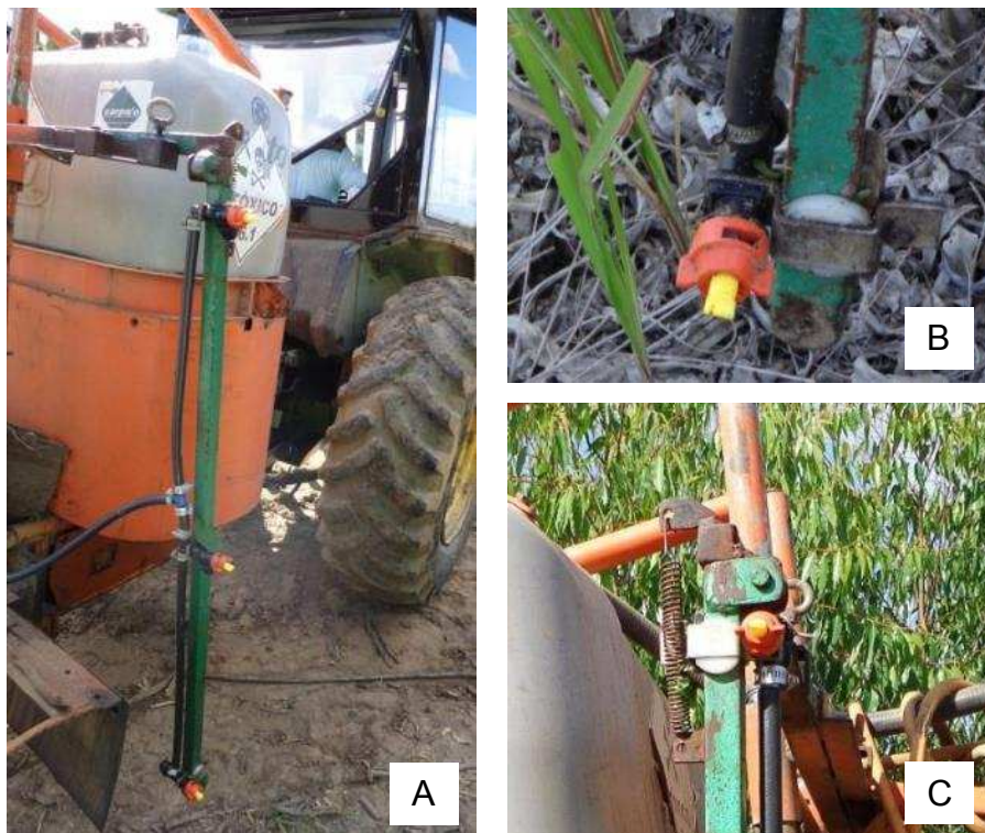
Figura 3 - Vista da barra de pulverização (A), do corpo do bico e da ponta de pulverização (B) e da mola de absorção de impactos (C).
