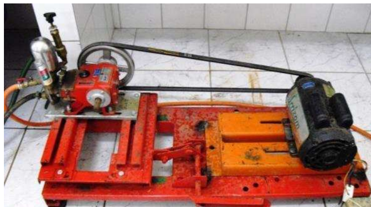
Figura 1 - Bomba hidráulica utilizada no experimento.
