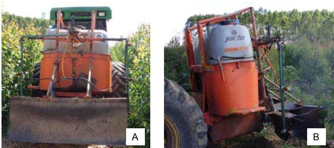
Figura 3 - Vista frontal (A) e lateral (B) da barra porta-bicos do pulverizador hidráulico.
