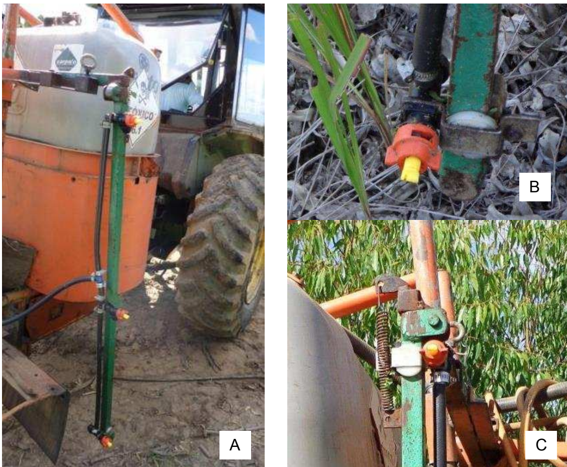
Figura 4 - Vista da barra de pulverização (A), do corpo do bico e da ponta de pulverização (B) e da mola de absorção de impactos (C) do pulverizador hidráulico.
