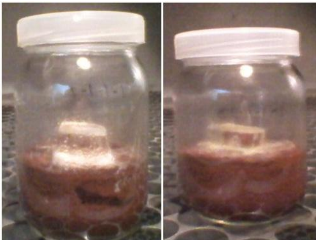
Figura 5-2: Frascos de ensaio contendo corpos de prova na 12ª semana sob o ataque dos fungos. À esquerda o fungo Trametes versicolor e à direita o fungo Gloeophyllum trabeum .
