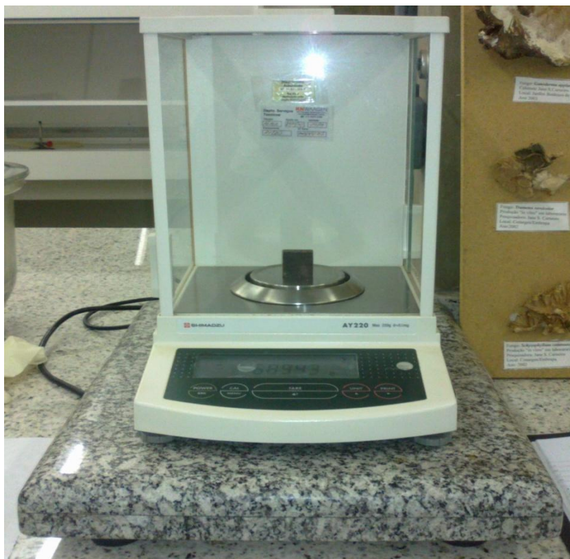
Figura 9-2: Balança analítica, modelo AY 220 Shimadzu, com precisão de 0,0001 g utilizada na pesagem dos corpos de prova.
