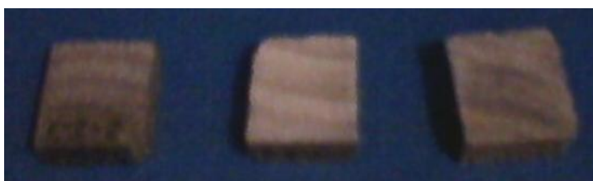
Figura 9-1: Corpos de prova antes da inoculação dos fungos. Dimensões de 25 x 25 x 9 mm (comprimento x largura x espessura).
