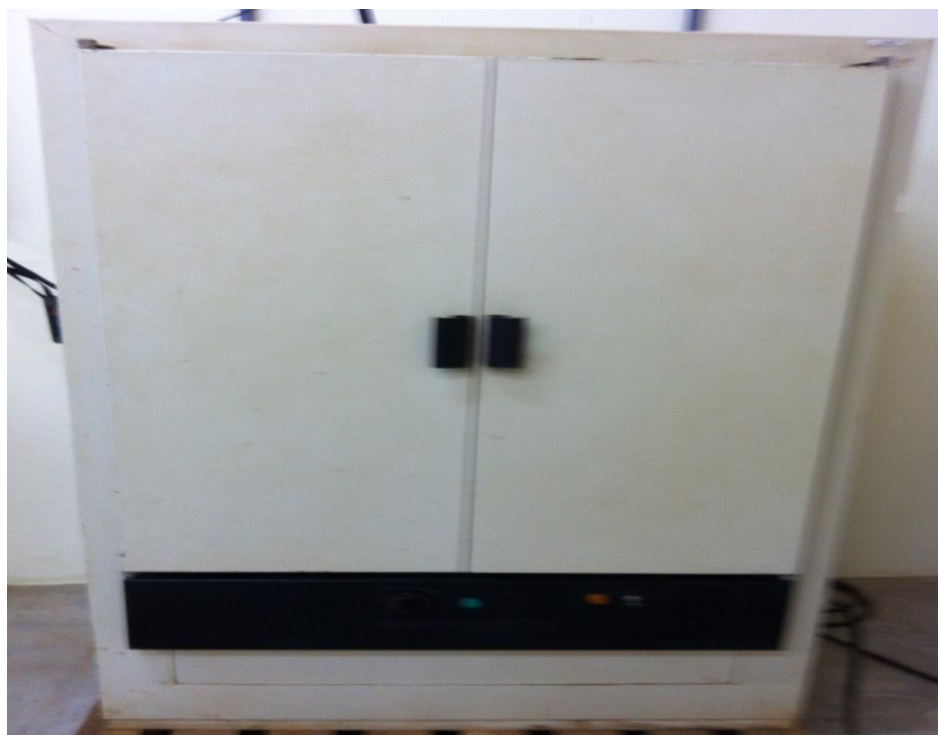
Figura 9-3: Estufa de circulação mecânica de ar FANEM, modelo 320-SE utilizada na realização dos tratamentos térmicos.
