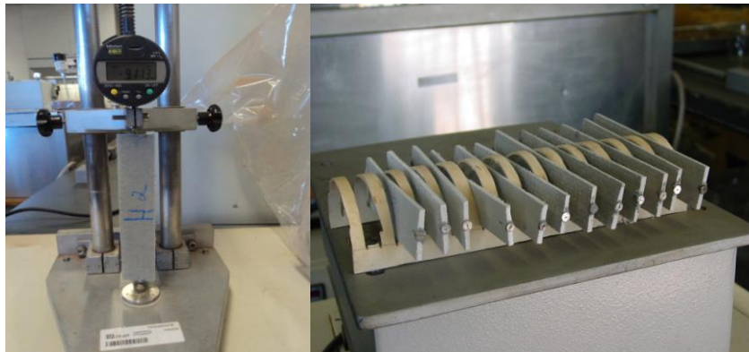
Figura 7 Aparato para medição da variação dimensional dos compósitos e amostras prontas para o ensaio
