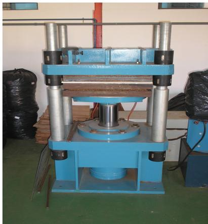
FIGURA 3.3 Processo de prensagem a quente dos painéis.
