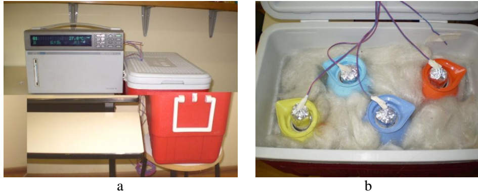
Figura 2 a) Sistema de aquisição de dados e caixa térmica acoplada para os testes de aptidão e b) vista interna da caixa térmica, detalhe das garrafas utilizadas para armazenar as amostras.
