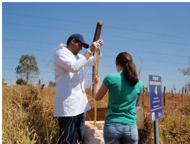
Figura 6 Medição do nível de água no poço de monitoramento
