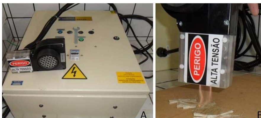
Figura 12 A-Equipamento de tratamento corona e B-Descarga elétrica sendo aplicada no material lignocelulósico
