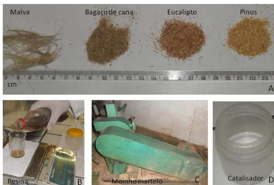
Figura 9 A-Matéria-prima e equipamentos utilizados, B-Resina poliéster insaturada ortoftálica, C-Moinho martelo utilizado para geração de partículas e D-Catalisador peróxido de metil-etil-cetona
