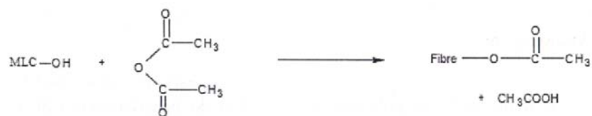
Figura 7 Reação de acetilação do material lignocelulósico (MLC) com anidrido acético Fonte: Abreu (2011)
