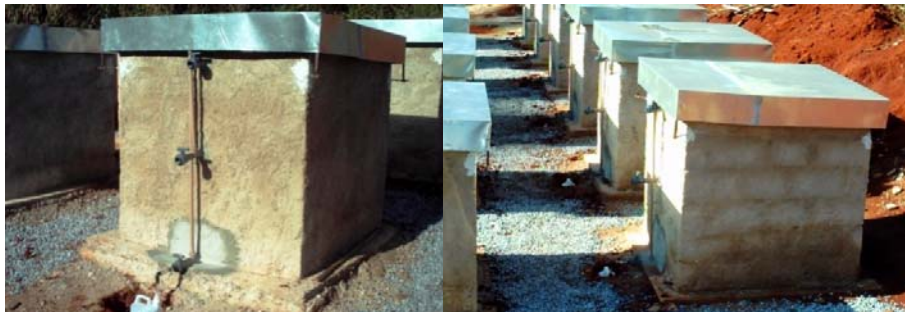
Figura 6 Célula experimental com sistema de drenagem de líquidos, gases e sistema de cobertura em Lavras - MG.
