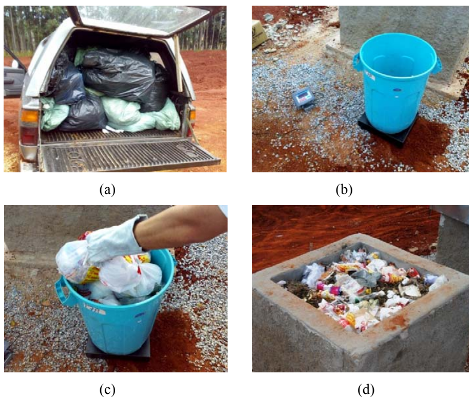
Figura 8 a) Material coletado nos bairros selecionados para amostragem; b) Equipamento utilizado para a pesagem dos resíduos e solo; c) Pesagem dos RSU; d) Deposição dos RSU no interior das células experimentais para posterior compactação.
