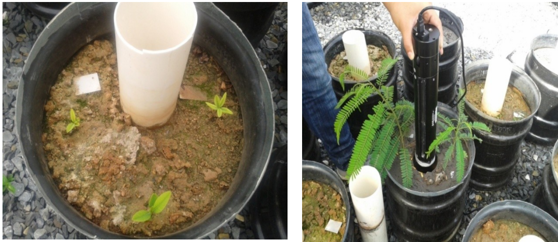
FIGURA 2: Detalhes do cano de PVC no orifício para avaliação das raízes(A) e uso do equipamento CI 600 Root Manager (B)
