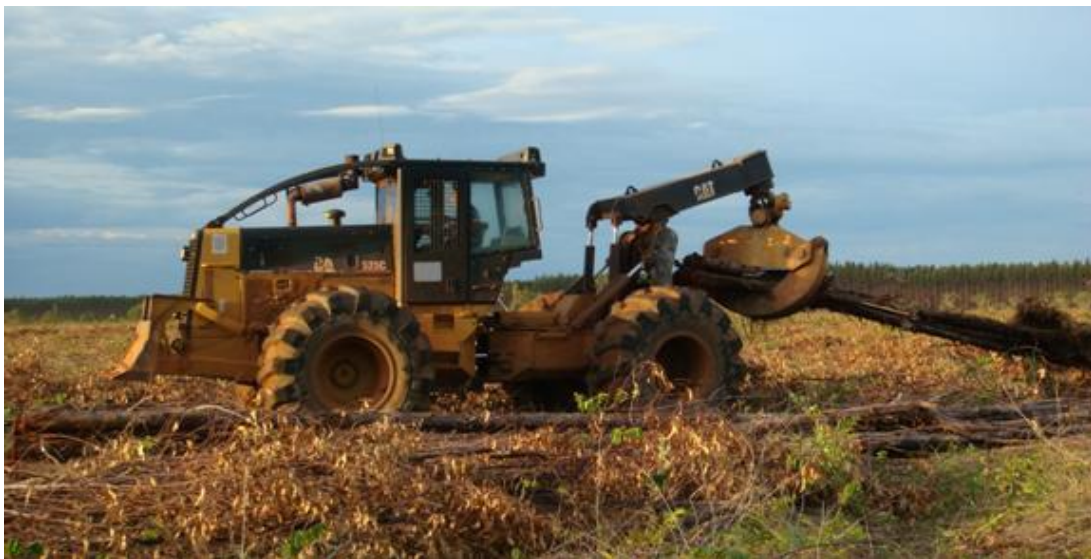
Figura 7: Imagem do Skidder utilizado na colheita florestal da empresa.
