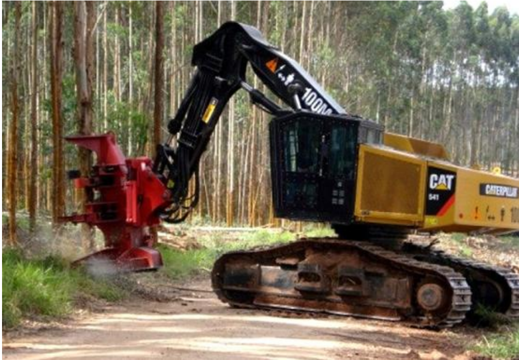
Figura 6: Imagem de um modelo similar ao Feller buncher utilizado na colheita florestal da empresa. (Fonte: CAT Brasil – 2014)
