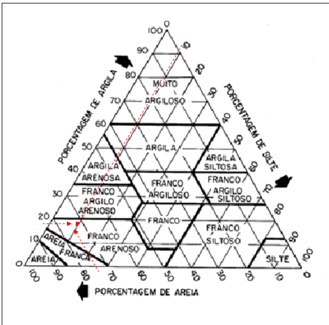
Figura 3.8 - Diagrama triangular com as diversas classes de textura de um solo (LEMOS & SANTOS, 1984). Em vermelho, a classificação do solo da área de lavoura do estudo.
