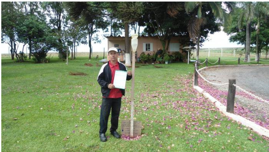
Figura 3.4 - Pluviômetro instalado na área de estudo.
