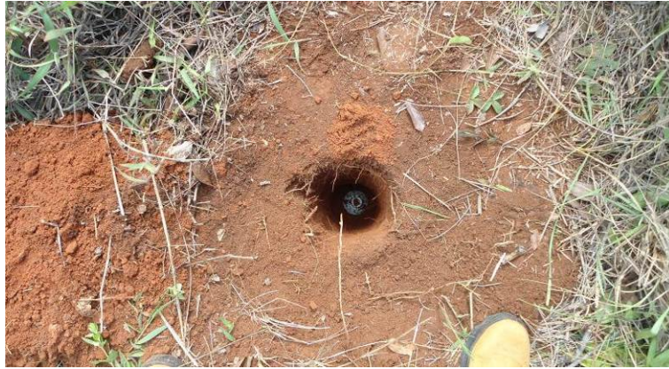
Figura 3.21 - Instalação de coletores de material percolado na área testemunha.
