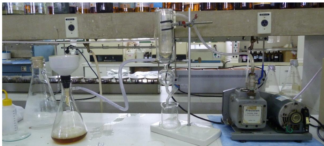
Figura 24. Conjunto filtrante usado para a retirada de umidade do colchão de partículas.
