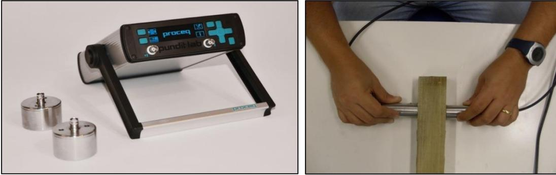
**Figura 5.** Equipamento de ultrassom Pundit Lab - Proceq e medição de ondas ultrassônicas em uma amostra de madeira no sentido transversal.
