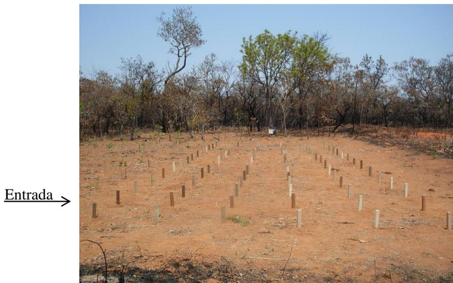
**Figura 2.** Campo de apodrecimento experimental instalado na Fazenda Água Limpa (FAL/UnB).
