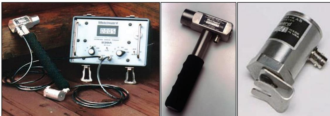
**Figura 4.** Equipamento Stress Wave Timer. Detalhes do transmissor tipo martelo e do receptor para uso em campo. (METRIGUARD, 2010).
