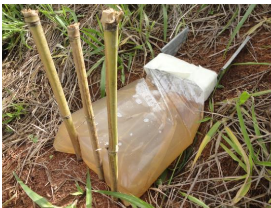
Figura 12. Coletor de erosão utilizado para a captação da água proveniente do escoamento superficial. Assentamento Olga Benário, Visconde do rio Branco, MG.
