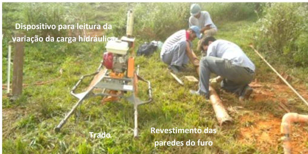
Figura 15: Indicação de parte dos equipamentos utilizados para a realização dos ensaios de permeabilidade.
