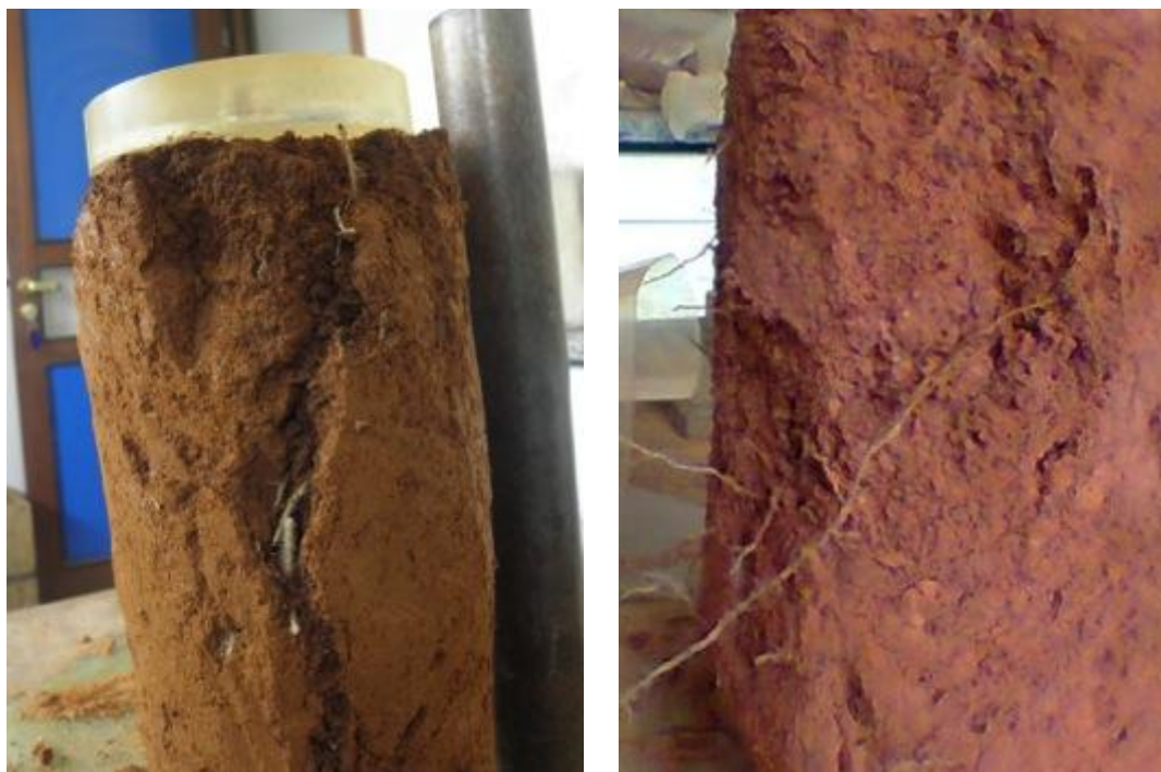
Figura 43: Presença de fraturas (a) e raízes (a e b) nas amostras, que por vezes, impediam a moldagem dos corpos de prova.
