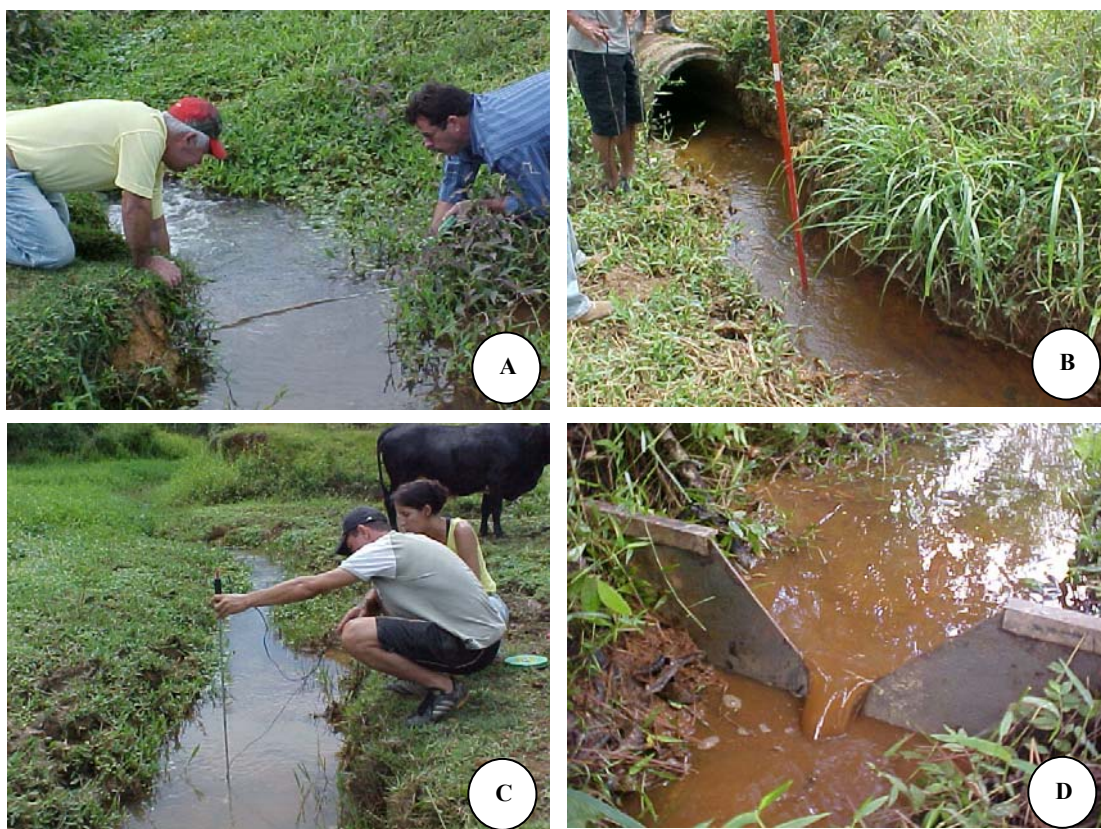
Figura 14 - Medição da vazão na bacia hidrográfica do RSB. (A) Largura da seção horizontal. (B) Determinação da profundidade em diferentes seções transversais. (C) Método do Molinete. (D) Método do vertedor.
