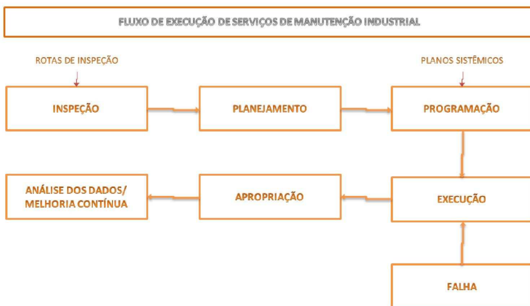
Figura 1. Fluxo de execução de serviços de manutenção de fábricas de celulose.
