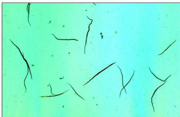
Figura47: Placa de vidro com fibras prensadas para avaliação de RBA – CyberFlex.
