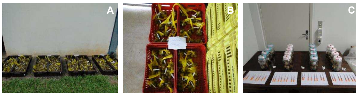
Figura 3 – Tratamento dos frutos com solução de Ethrel (A); armazenamento dos frutos (B); Acúmulo de gases em frascos herméticos para análise cromatográfica (C).
