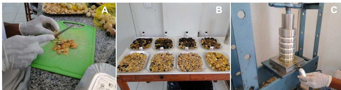
Figura 5 – Etapas de extração do óleo do mesocarpo. (A) Despolpa dos frutos; (B) Organização das amostras para prensagem; (C) Prensagem do mesocarpo e acondicionamento do óleo em frascos âmbar, envoltos por papel alumínio.
