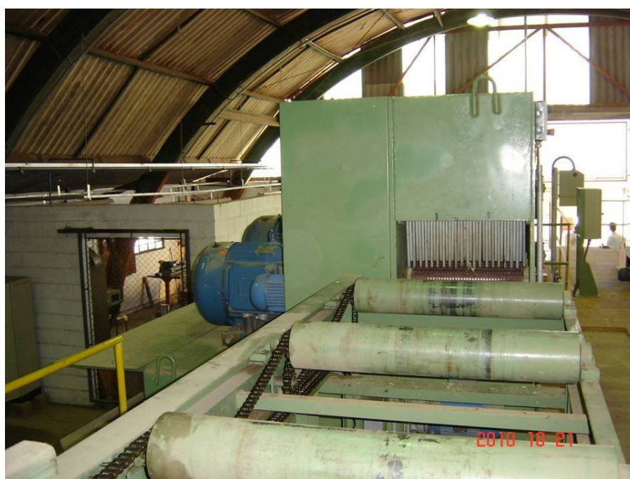
Figura 20. Serra multilâminas no Laboratório de Processamento da Madeira da UNESP, campus de Itapeva.
