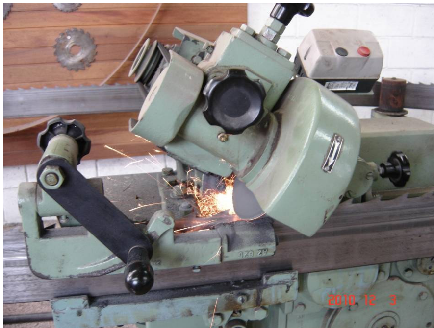
Figura 23. Processo de afiação de serra no Laboratório de Processamento da Madeira da UNESP, campus de Itapeva.
