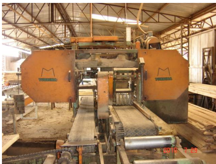
Figura 22. Serra de fita horizontal na Serraria C.
