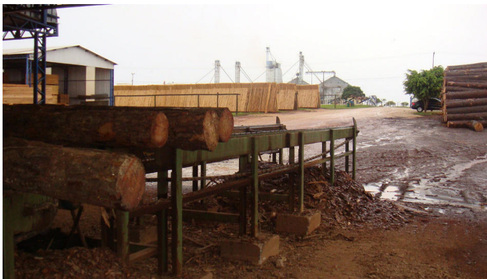
Figura 15. Mesa de entrada das toras instalada na Serraria C.
