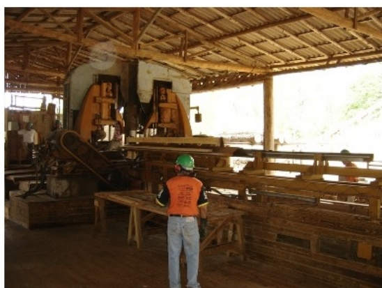
Figura 19 – Processamento das toras de Pinus elliottii . A) Detalhe do desdobro com uso de serra fita. B) Tábuas de madeira após desdobramento e antes do refilamento.
