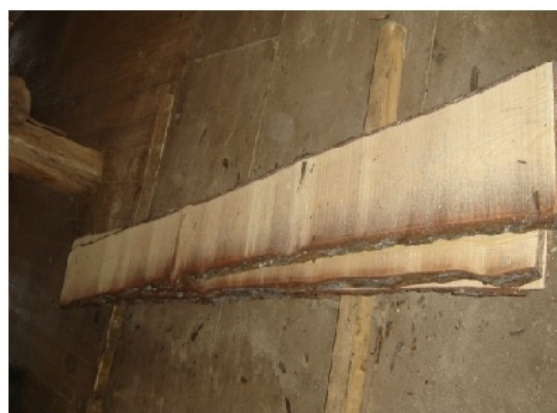
Figura 19 – Processamento das toras de Pinus elliottii . A) Detalhe do desdobro com uso de serra fita. B) Tábuas de madeira após desdobramento e antes do refilamento.
