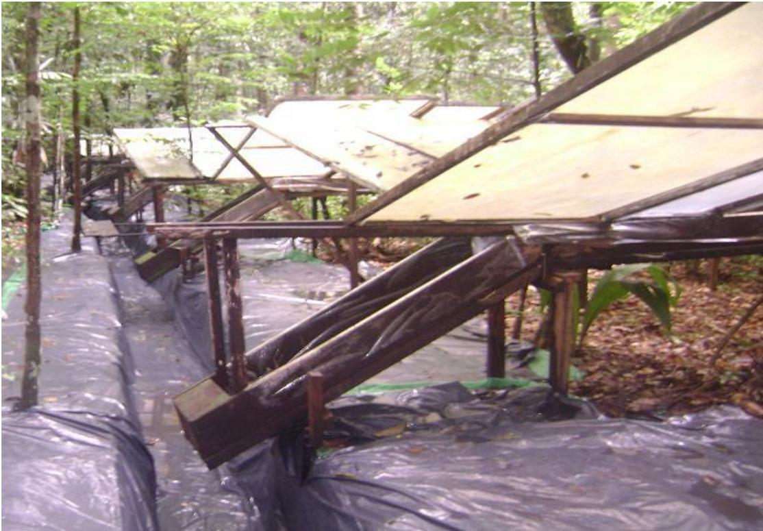
Figura 09 – Calhas que fazem o transporte da água da precipitação pluvial excluída até as trincheiras.
