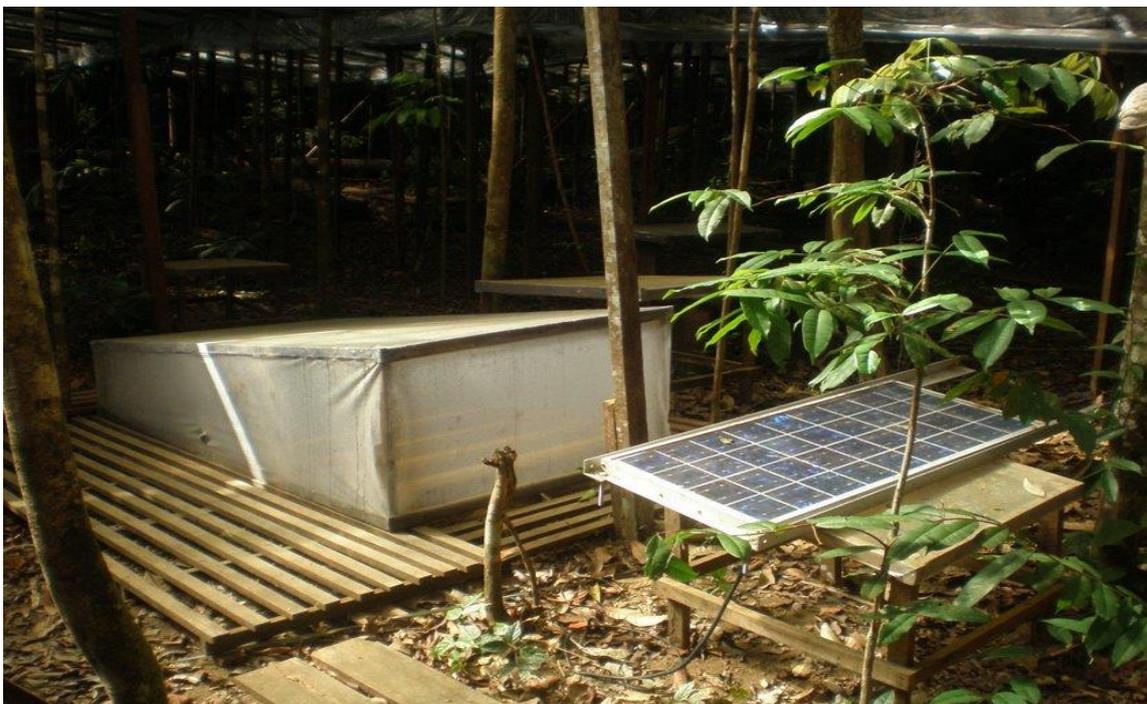
Figura 10 – Poço de medição fechado e protegido, instalado na parcela “B” e painel fotovoltaico de alimentação dos sensores.
