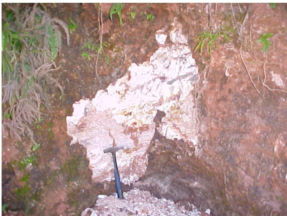
Foto 04 – Detalhe do solo residual jovem existente em corte situado na porção Oeste da área de pesquisa.
