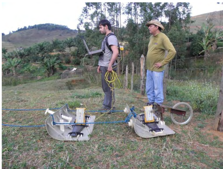
Figura 29: Trenó com GPR em campo.
