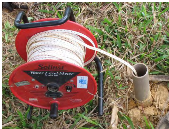
Figura 25: Medidor elétrico em operação.
