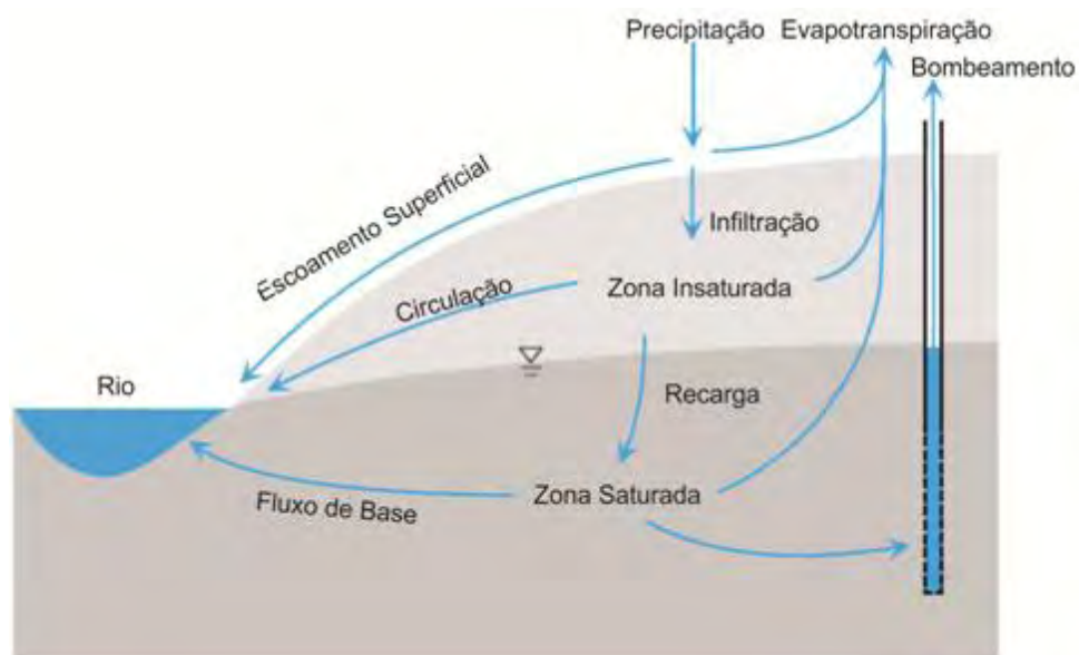
Figura 2: Fluxos da água no perfil do solo / Fonte: Adaptado de Fitts (2002).
