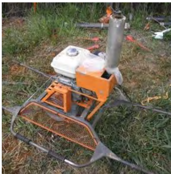
Figura 21: Trado mecânico / Fonte: Betim (2013).
