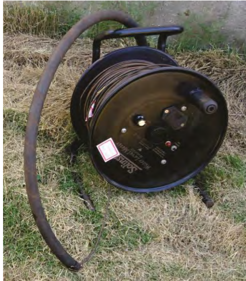
Figura 27: Equipamento utilizado como slug nos ensaios.
