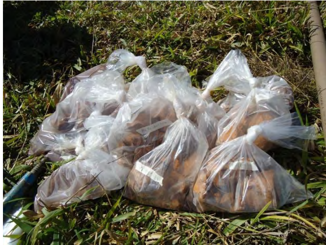
Figura 22: Amostras de solo condicionadas para análise tátil-visual.
