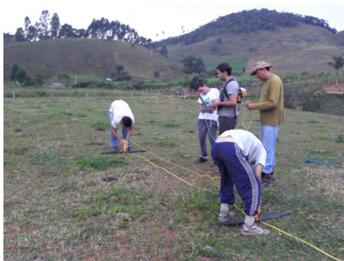
Figura 30: Sondagem de velocidade através da técnica CMP.
