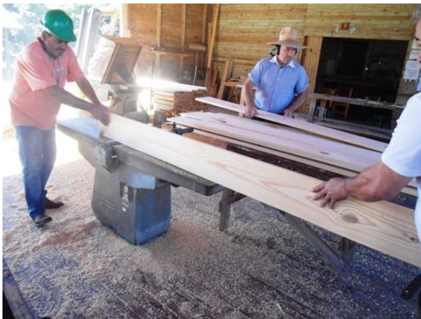
Figura 15 – Procedimento de aplainamento das tábuas na carpintaria do Horto Florestal de Manduri - SP.
