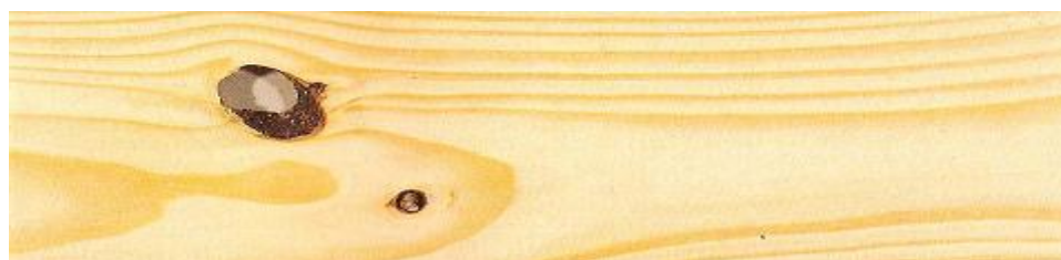
Figura 8 - Presença de nó vazado em tábua de Terceira classe
