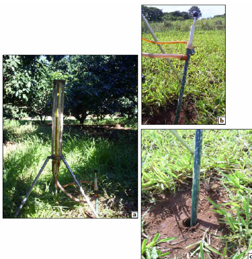
Figura 9. Permeâmetro de Guelph (a), detalhe da carga hidráulica (b) e orifício (c).
