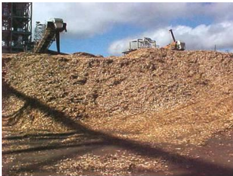
Figura 2.11: Pátio de cavacos ao ar livre. Fonte: Duratex S.A. (2006).
