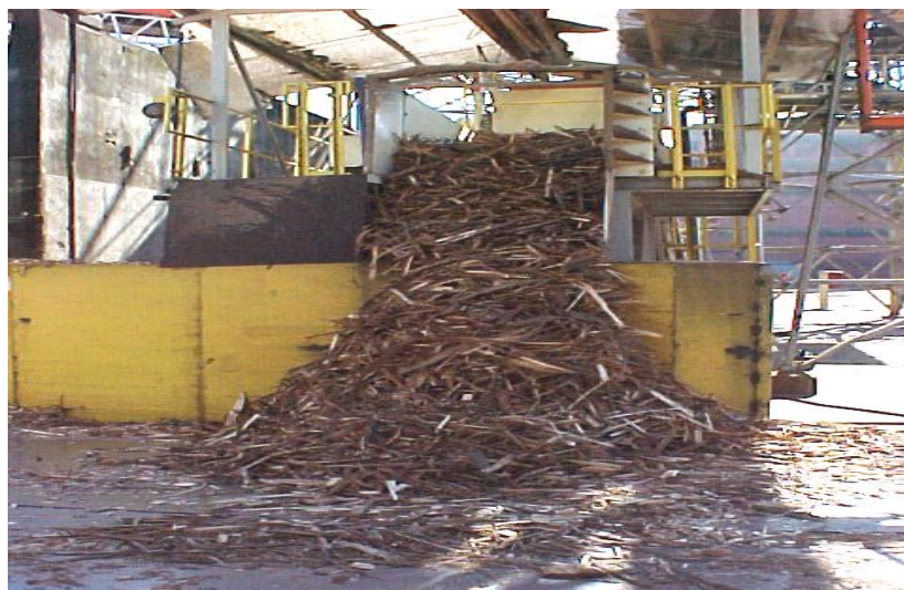
Figura 3.4: Peneira de discos do processo de fabricação de chapa dura. Fonte: Duratex S.A. (2006).
