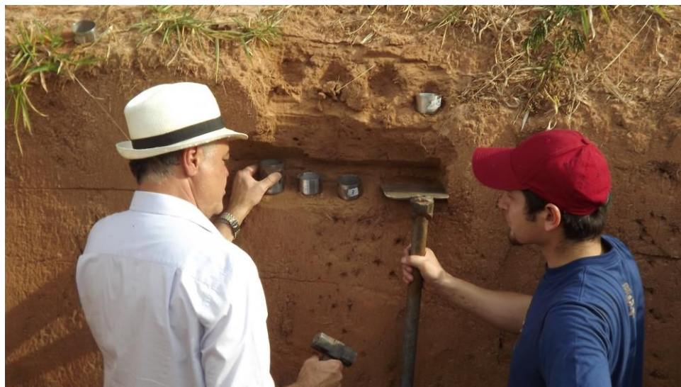
Figura 5. Processo para coleta de amostras de solo em trincheira.
