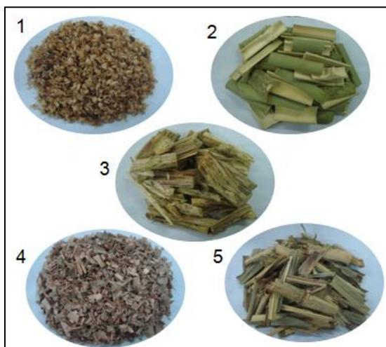
**Figura 1** – Biomassas utilizadas. (1) casca de café, (2) bambu, (3) bagaço de cana-de-açúcar, (4) serragem de eucalipto e (5) capim-elefante.
