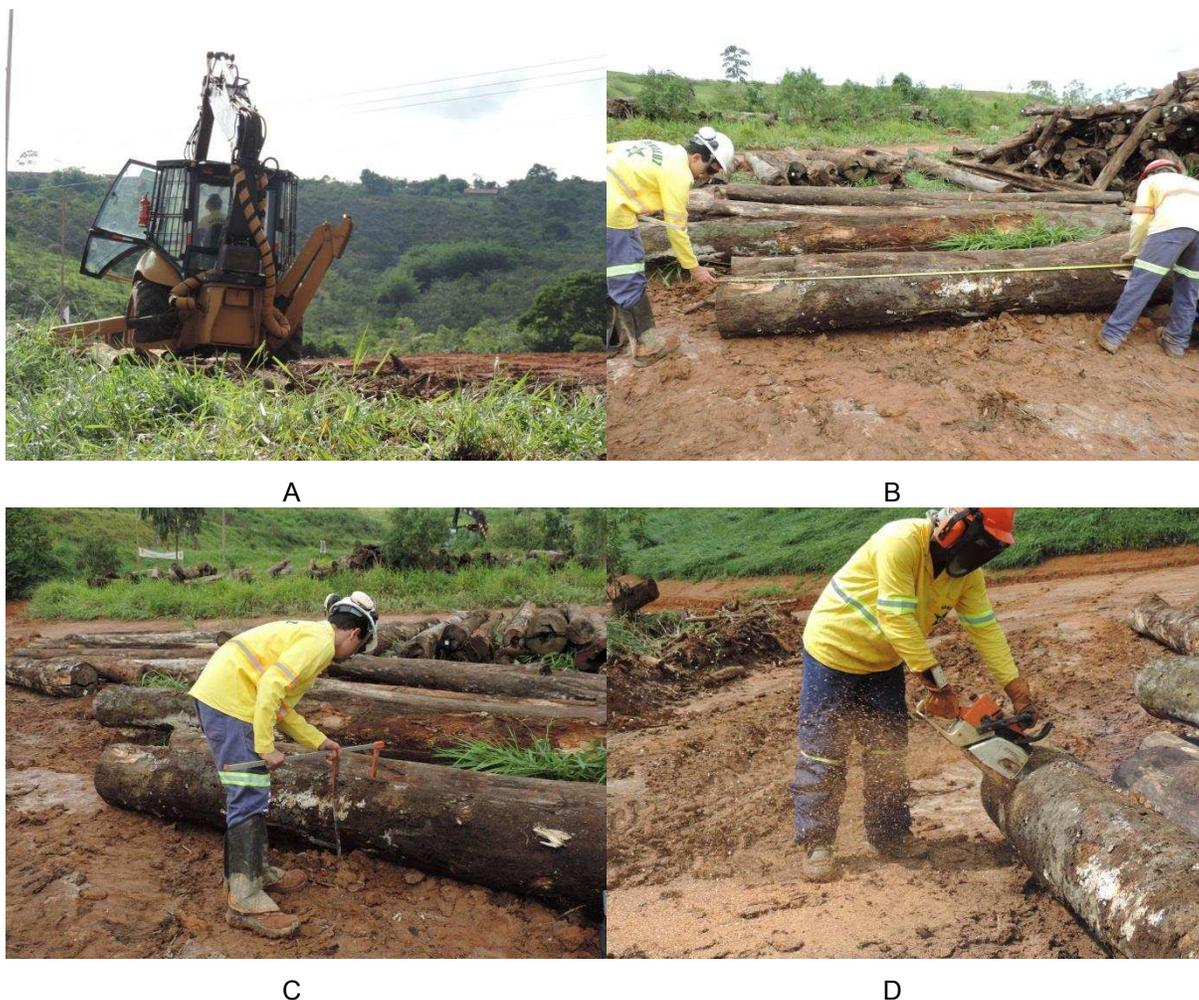
Figura 17 – Cubagem rigorosa. A: Carregador florestal utilizado para dispor as toras paralelamente ao solo. B: medição do comprimento da tora. C: medição do diâmetro central. D: remoção de partes inutilizáveis das toras.
